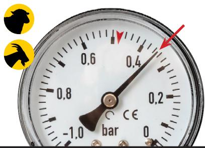
În ambele cazuri, asigurați-vă că nivelul de vid nu depășește -0,5 bar! Dacă nivelul de vid nu este corespunzător, îl puteți regla folosind regulatorul de vid montat pe aparat.
