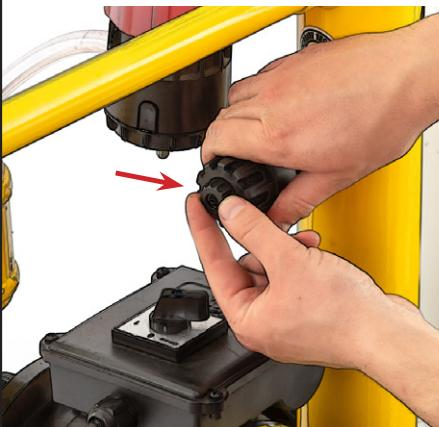
Ajustați poziția regulatorului până când atingeți nivelul optim de vid. În timpul reglajului, eliberați periodic regulatorul, deoarece atingerea acestuia poate influența reglarea vidului.
