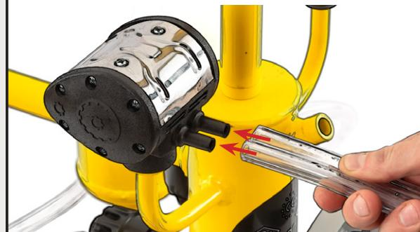
Montați cu grijă vacuummetrul în locașul prevăzut pe aparat, având grijă să nu îl deteriorați.
