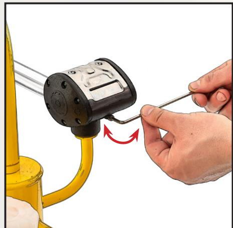
regolatore di vuoto. Se il sistema mantiene il livello di vuoto, la pompa è in funzione e si può continuare con la seguente verifica:
