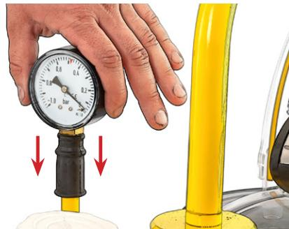
Conectați bidonul și aparatul folosind furtunul de vid scurt. Pe capacul bidonului fixați furtunul la racordul unde este montat opritorul de lapte.
