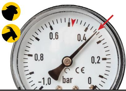
In entrambi i casi, assicurarsi che il livello di vuoto non superi i -0,5 bar! Se il livello di vuoto non è adeguato, è possibile regolarlo utilizzando il regolatore di vuoto montato sull'apparecchio.
