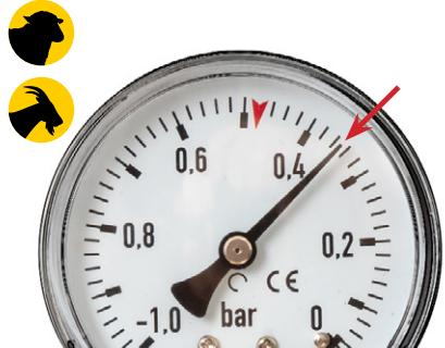
Mindkét esetben ügyeljen, hogy a vákuum szintje ne haladja meg a -0,5 bar-t! Ha a vákuumszint nem megfelelő, a gépen található vákuumszabályzóval állíthatja.
