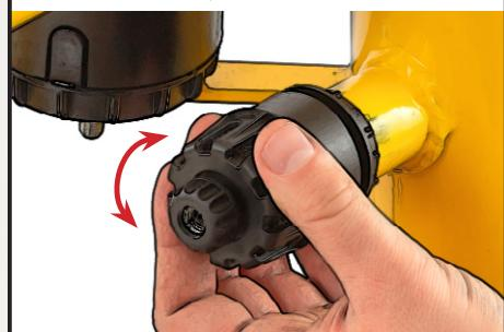
След приключване на регулирането затегнете здраво фиксиращата гайка, без да позволявате на врътката да се размести.
