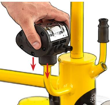
Csatlakoztassa a pulzátorhoz a fejő-egység(ek)ből érkező vékonyabb vákuumtömlőket.
