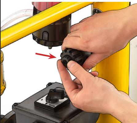
Настройте регулатора, докато достигнете оптималното ниво на вакуум. По време на настройката понякога го отпускате, тъй като допирът може да даде фалшиви показания на манометъра.
